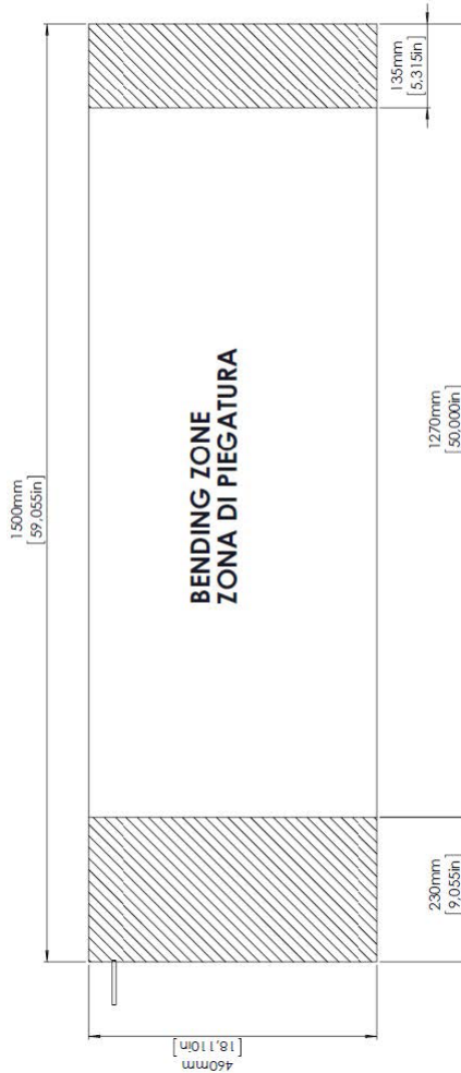
Figura 21: Zone di piegatura Evaporatore 1500x460
