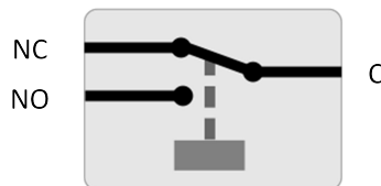
Intern drift av det programmerbara reläet
