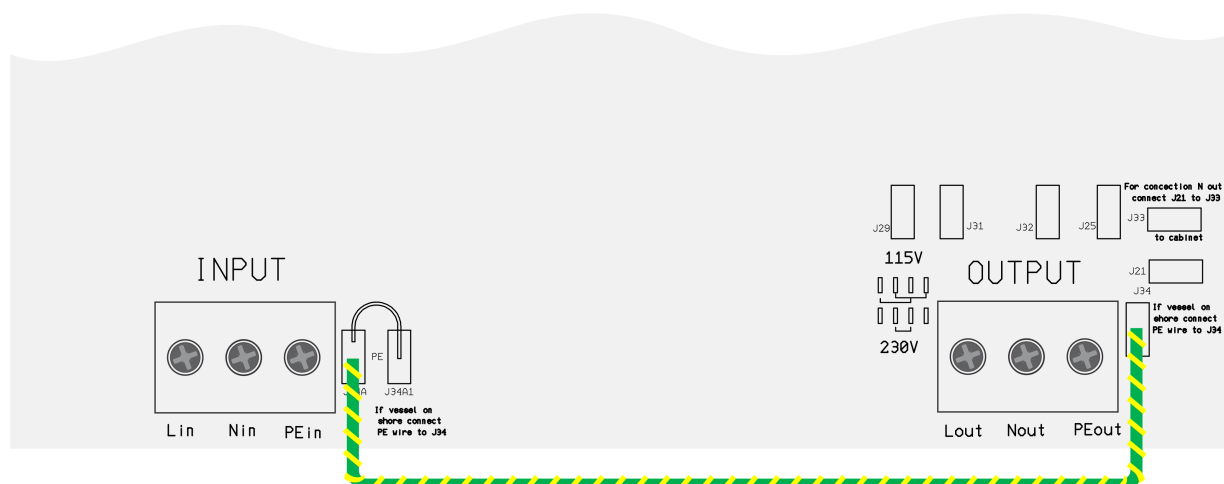
AC-ingångsjorden är ansluten till AC-utgångsjorden när fartyget befinner sig på land under vintern eller för underhåll.
